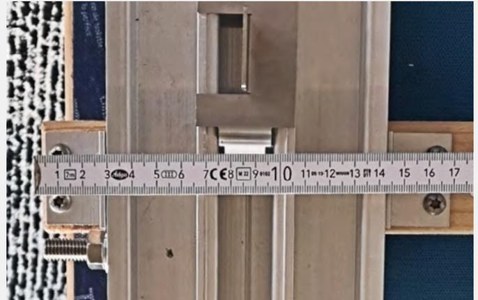
2: IP-Profil Abmessungen Breite mit Haltewinkeln beidseitig
