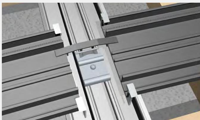
5. Das TR-H Profil wird mit leichtem Gefälle montiert, indem auf einer Seite der TR-C Clip an der zweitobersten Rippe und auf der anderen an der oberen Wölbung anschlägt.
