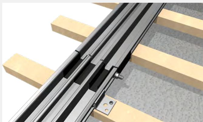
4. IP Verlängerungsprofil in den IP-C Verbinder schieben. Dehnungsspalt von ca 4 mm vorsehen. Jedes IP-Profil ist an der Profilunterkante mit einer Hammerkopfschraube zu sichern.
