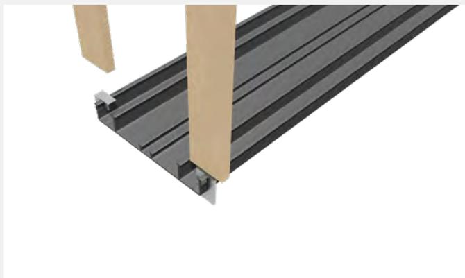
4. Die oberen Laschen des TR-H Abtropfbleches z. B. mit einer Holzplatte nach unten biegen.
